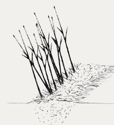
Reboucher la tranchée
